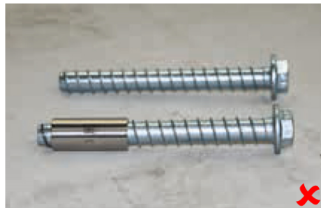
La vite scorre completamente nella dima e esce la punta: la vite non può più essere riutilizzata!
