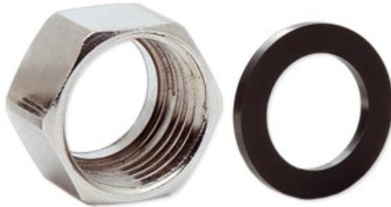
Dado in ottone nichelato a sede speciale con filettatura femmina ISO 225 G a battuta piana e guarnizioni piane in NBR a norma EN 682 per gas. Nipplo M/M in ottone nichelato con doppia filettatura maschio ISO 228 G a battuta piana (A-B). Dado, guarnizione e nipplo idonei per tubo corrugato gas in acciaio inox AISI316L codice di riferimento F3896 901 050 e codici a seguire.
