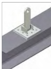
ACCIAIO Mediante imbullonatura o saldatura [previa rimozione della zincatura]
