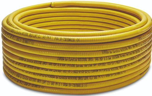
Tubo corrugato per gas in acciaio inox AISI 316L resistente a ossidazione, corrosione e deformazione. Il tubo, con rivestimento giallo in LDPE a norma UNI EN 15266 è idoneo per impianti gas.
