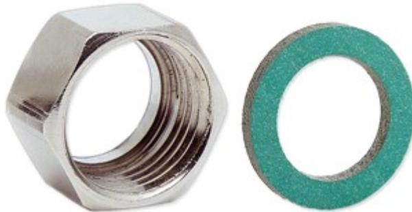
Dado in ottone nichelato a sede speciale con filettatura femmina ISO 228 G a battuta piana e guarnizioni piane KLINGERSIL C4324 a base di fibre sintetiche idonee al trasporto di acqua potabile e resistenti a temperature operative continue di 250°C (liquidi) e 200°C (vapori). Dado e guarnizione idonee per tubo corrugato acqua in acciaio inox AISI 304 codice di riferimento F3896 901 150 e codici a seguire.
