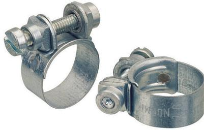
La fascetta stringitubo NORMA offre un elevato grado di compressione grazie alla sua robusta struttura a ganascia di serraggio, dotata di viti metriche. Questa fascetta stringitubo è prodotta secondo DIN 3017 ed è adatta per il fissaggio di tubi flessibili in gomma o plastica, manicotti in gomma e per il fissaggio su estremità di tubi o connettori per tubi flessibili. Queste fascette stringitubo possono essere utilizzate anche per il montaggio di airbag nell'industria automobilistica.
