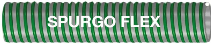
Tubo in PVC con spirale PVC idoneo per aspirazione e mandata di liquidi nel settore agricolo dove sia richiesta una buona flessibilità. Indicato per spurghi di fognature, pozzi neri e aspirazione liquami su carri botte.
