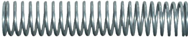
Spirale di protezione in acciaio zincato a sezione tonda utilizzata nelle applicazioni gravose che richiedono una protezione dei tubi oleodinamici contro tagli e abrasioni ed allo stesso tempo offrono una discreta resistenza alla curvatura eccessiva.
